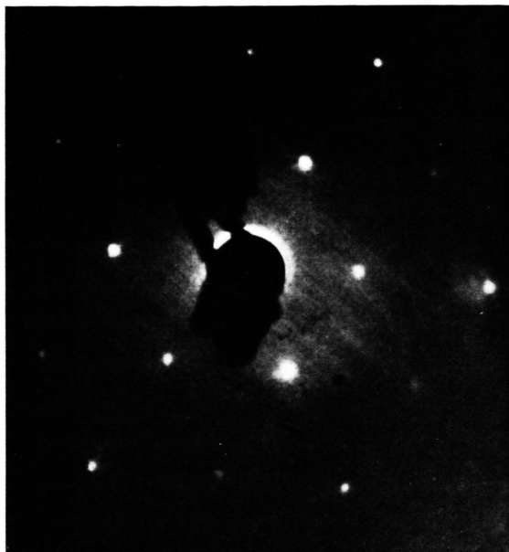
Abb. 2. Beugung an derselben Fläche nach Einwirkung von 10^{-4} Torr·sec Sauerstoff, 70 V, bei Raumtemperatur.
